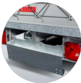
Serienmäßig mit integrierten Halteungen für Auffahrampen ausgestattet
