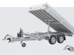
KSX Rückwärtskipper mit Handpumpe
