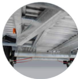
Uiterst stabiel chassis met optimale vloerondersteuning
