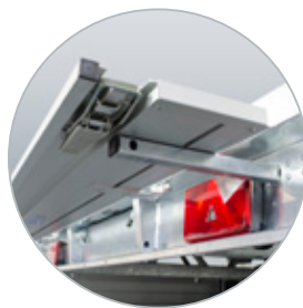
Achterklepondersteuning d.m.v. uittrekkers
