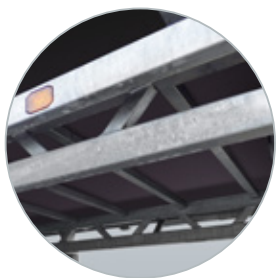
Robuust vakwerkchassis uit kokerprofielen
